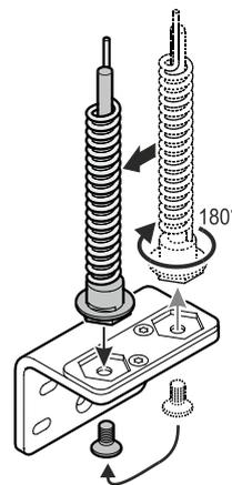
5. Lagerbolzen abschrauben, horizontal um 180° drehen und in der linken Öffnung anschrauben.
