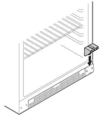
12. Transportsicherung aufsetzen.
