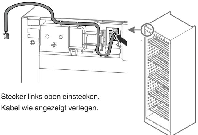
13. Stecker links oben einstecken. Kabel wie angezeigt verlegen.
