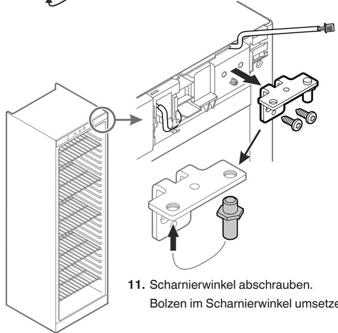
11. Scharnierwinkel abschrauben. Bolzen im Scharnierwinkel umsetzen.
