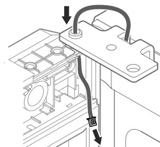
24. Tür öffnen. Kabel vollständig durch die Öffnung ziehen.
