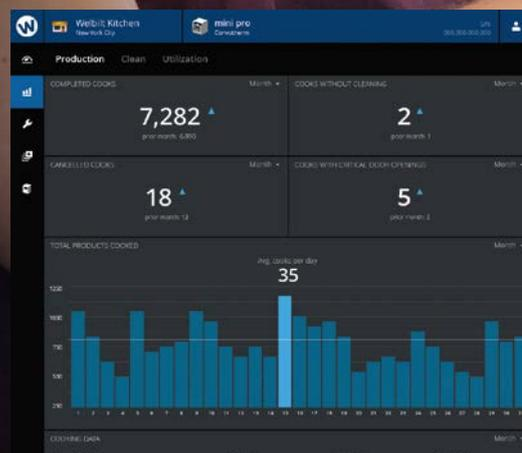
Anzeige von qualitätsrelevanten Ereignissen, z. B. ausgelassene Reinigungszyklen oder abgebrochene Garvorgänge.
