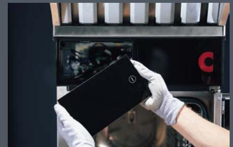
**Einfacher Service für längere Lebensdauer:** Abnehmbare Verkleidungen ermöglichen den einfachen Zugang zu allen Komponenten. Weniger Bauteile reduzieren Wartungskosten und Ausfallzeiten
