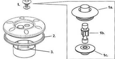
4. Vor dem Zusammensetzen des Deckels überprüfen, dass alle Teile vollständig trocken sind. Ventil (**1**) komplett zusammensetzen und so im Deckel platzieren, dass eine korrekte Position der Dichtung (**1c.**) gewährleistet ist. Weitere Teile des Deckels gemäß Abbildung anbringen.
