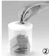
Über den Verbindungsschlauch den Deckel an die Luftanschlusssdüse der Vakuum-Verpackungsmaschine anschließen.
