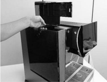
1. Ziehen Sie den Wassertank vom Gerät ab.
