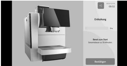
Starten Sie das Entkalkungsprogramm, wenn die Meldung „Entkalkung“ auf dem Bildschirm erscheint. Für die Entkalkung kann Entkalkungspulver oder flüssiger Entkalker verwendet werden.
