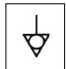
Das Gerät muss weiters mit einem POTENZIAL-Ausgleich verbunden sein. Die Klemmleiste für den Anschluss befindet sich nahe der Öffnung für das Versorgungskabel und ist durch ein Etikett mit dem Symbol gekennzeichnet.
