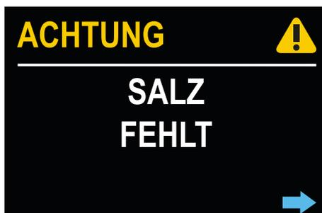
Durch Drücken der **Info-Taste E** versetzt sich das Display in den Modus Maschine Startbereit. Die Meldung erscheint im unteren Teil des Displays abwechselnd zum Namen des Spülprogramms als Laufschrift. Die Meldung erscheint so lang bis Salz nachgefüllt wird.
