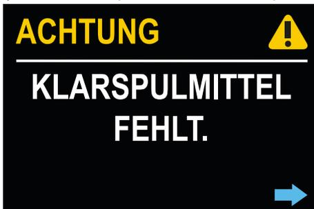
Durch Drücken der **Info-Taste E** versetzt sich das Display in den Modus Maschine Startbereit. Die Meldung erscheint im unteren Teil des Displays abwechselnd zum Namen des Spülprogramms als Laufschrift. Die Meldung erscheint so lang bis das Kanister ersetzt wird.
