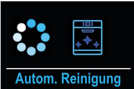
Die taste **Start F** drücken; der einminütige automatische Selbstreinigungszyklus wird ausgeführt. Im Anschluss daran bleibt die Maschine in **STAND-BY**. Auf dem Display wird die Meldung **AUTOMATISCHE REINIGUNG BEENDET** angezeigt.
