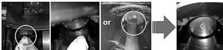
2. Reinigen Sie den Metallfilter, indem Sie mit Ihrer Hand und einem weichen Tuch oder weichen Bürste vorsichtig durch die Frontöffnung greifen und den Filter säubern.
