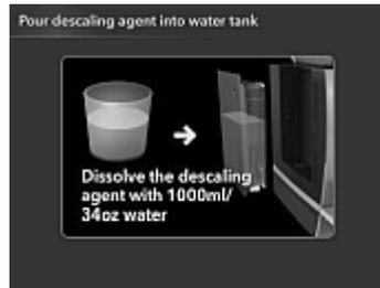
10. Lösen Sie den Entkalker in 1000 ml klarem Wasser vollständig auf, geben Sie diese Lösung in den Wassertank und setzen Sie den Wassertank wieder ein.
