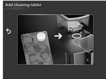
7. Öffnen Sie die Abdeckung des Mahlwerks und fügen Sie die Reinigungstablette ein.
