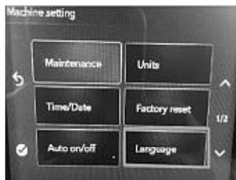
3. Durch Drücken der Einstelltasten „^“ und „v“ wählen Sie im Programmmenü die Option „Maschine“ und bestätigen Sie mit der Taste „MENU / OK“.
