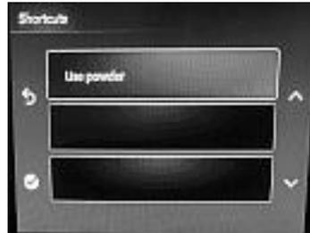
1. Drücken Sie die Einstelltaste „v“ auf der Bedienblende so lange, bis im Display „Verwende Pulver“ erscheint.
