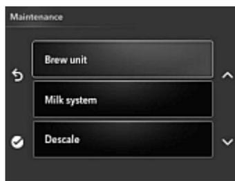
1. Drücken Sie 3 Sekunden lang die Taste „MENU / OK“, um in das Programmennü zu gelangen. Wählen Sie mit den Einstelltasten „^“ und „v“ die Option „Wartung“ aus und bestätigen Sie mit „MENU / OK“
