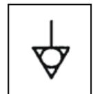
Das Gerät muss weiters mit einem POTENZIAL-Ausgleich verbunden sein. Die Klemmleiste für den Anschluss befindet sich nahe der Öffnung für das Versorgungskabel und ist durch ein Etikett mit dem Symbol gekennzeichnet.
