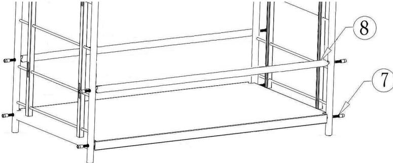
3. Beginnen Sie den Zusammenbau des Transportwagens mit der unteren Abstellfläche. Führen Sie die Seitenteile durch die Aussparungen in der unteren Abstellfläche und verschrauben Sie diese mit den Seitenteilen mit 4 M8x40 Schrauben. Ziehen Sie die Schrauben nicht zu fest an, um die Querstangen leichter zu montieren (**Abb. oben**).
