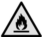
**WARNUNG:** Brandgefahr / brennbare Materialien. Das Symbol befindet sich am Verdichter und kennzeichnet die Gefahr vor feuergefährlichen Stoffen. Den Aufkleber nicht entfernen.
