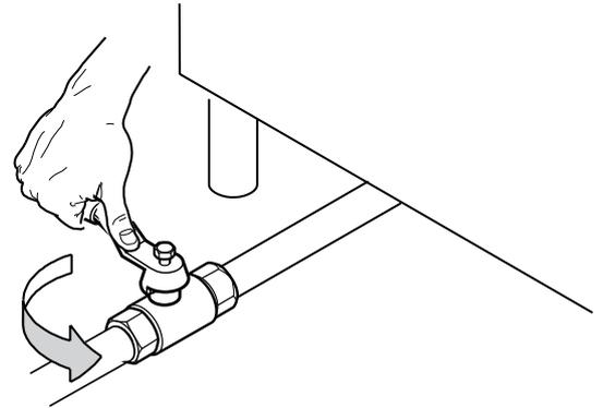
4. Reinigen Sie die Anschlussleitungen von Staub, Schmutz und Fremdkörpern, die die Gaszufuhr behindern könnten. Die Gasversorgungsleitung muss einen ausreichenden Gasdurchsatz für den einwandfreien Betrieb aller ans Gasnetz angeschlossenen Geräte gewährleisten. Eine unzureichende Gasversorgung beeinträchtigt den Betrieb der angeschlossenen Geräte.
