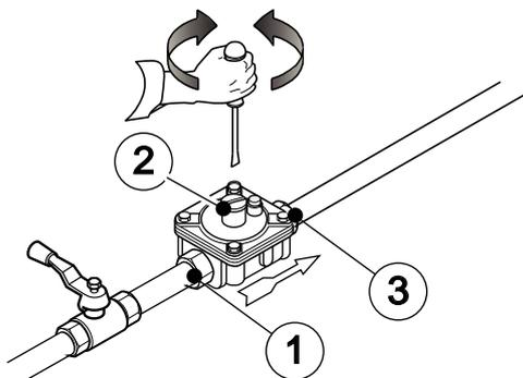
**Für Australien:** Justieren Sie den Druck am Messnippel mit den Brennern auf maximaler Stufe (siehe Anhang, Tabelle "B").
