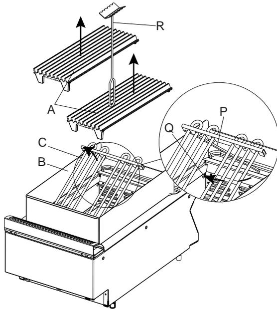
2. Die Heizelemente "C" anheben, die Stäbe "P" zur Abstützung um 90° drehen und den Bolzen in die Bohrung "Q" einsetzen.
