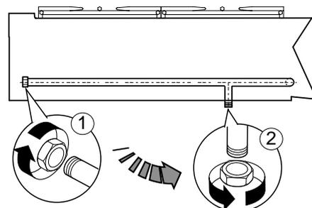
Nach erfolgter Installation die Dichtigkeit der Verbindungsstellen mit Seifenwasserlösung nachweisen.
