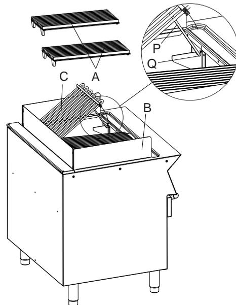
2. Die Heizelemente "C" anheben, die Strebe "P" zur Abstützung um 90 °C drehen und in die Raste der Halterung "Q" legen.
