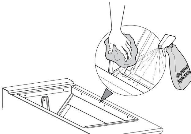
10. Die Flügel der Brennkammer, die das Fett in die Schublade leiten, mit einem Schaber oder ähnlichen Werkzeug reinigen.
