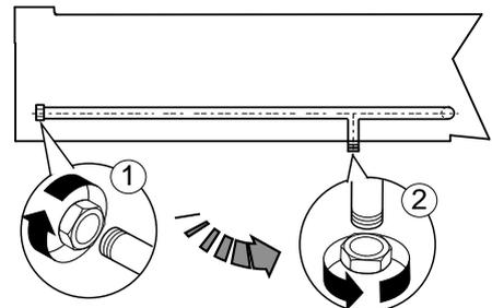
Nach erfolgter Installation die Dichtigkeit der Verbindungsstellen mit Seifenwasserlösung nachweisen.
