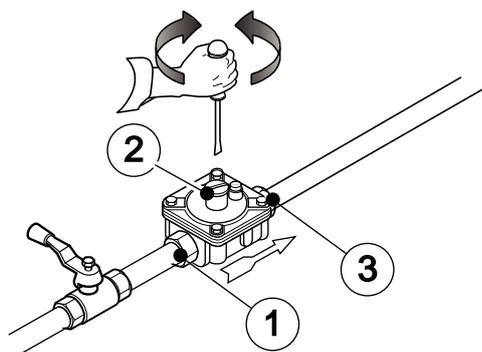
**AUSTRALIEN:** Der mit dem Gerät gelieferte Gasdruckregler muss an den Einlass am Gerät angeschlossen werden.
