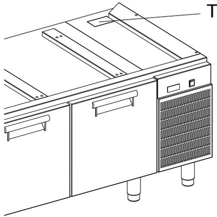
Nehmen Sie die ausgeschnittene Abdeckung "T" ab und schließen Sie den Ablauf des Grills an die Ablaufleitung an.
