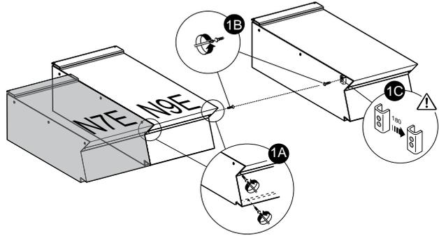
7. Vom Innern der Bedienblende desselben Geräts aus die beiden Geräte an der Vorderseite verbinden, indem eine M5x40-Sechskantschraube (mitgeliefert) in den gegenüberliegenden Einsatz geschraubt wird (Abb. 1E).
