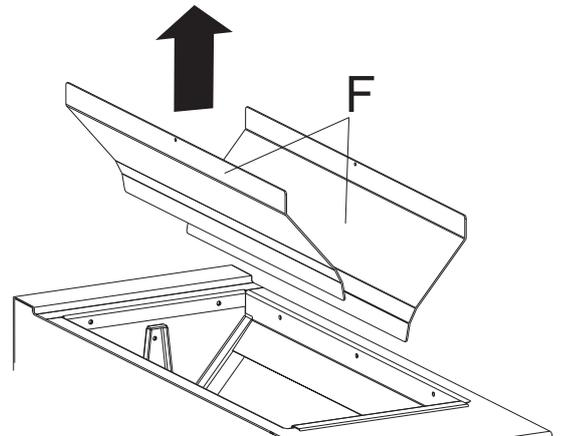
8. Den Brenner im Bereich der Flamme und entlang der Schlitze des Flammenschutzes reinigen.
