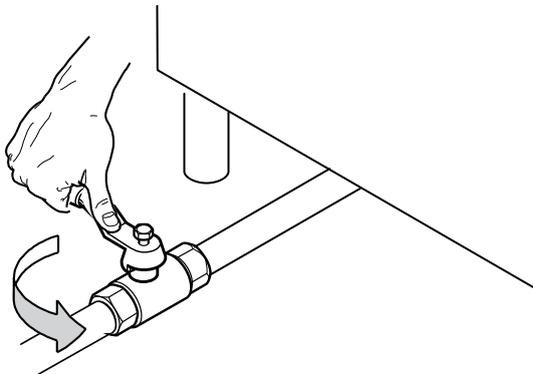
4. Reinigen Sie die Anschlussleitungen von Staub, Schmutz und Fremdkörpern, die die Gaszufuhr behindern könnten. Die Gasversorgungsleitung muss einen ausreichenden Gasdurchsatz für den einwandfreien Betrieb aller ans Gasnetz angeschlossenen Geräte gewährleisten. Eine unzureichende Gasversorgung beeinträchtigt den Betrieb der angeschlossenen Geräte.
