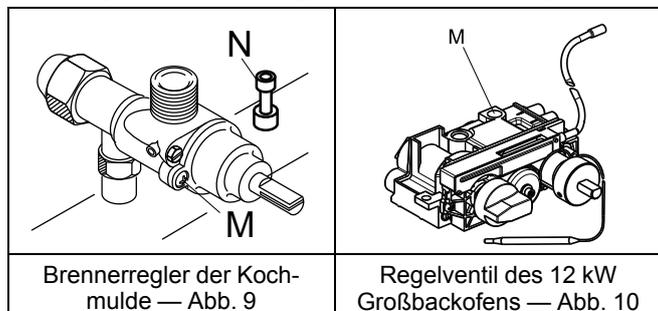
1. Die Schraube für die kleinste Flamme "M" aus dem Brennerregler bzw. Ventil herauserschrauben (siehe Brennerregler der Kochmulde — Abb. 9 und Regelventil des 12 kW Großbackofens — Abb. 10).
