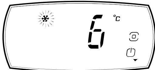
Raak gedurende 3 seconden de Programmatoets aan om het display te ontgrendelen en het apparaat te activeren en deactiveren
