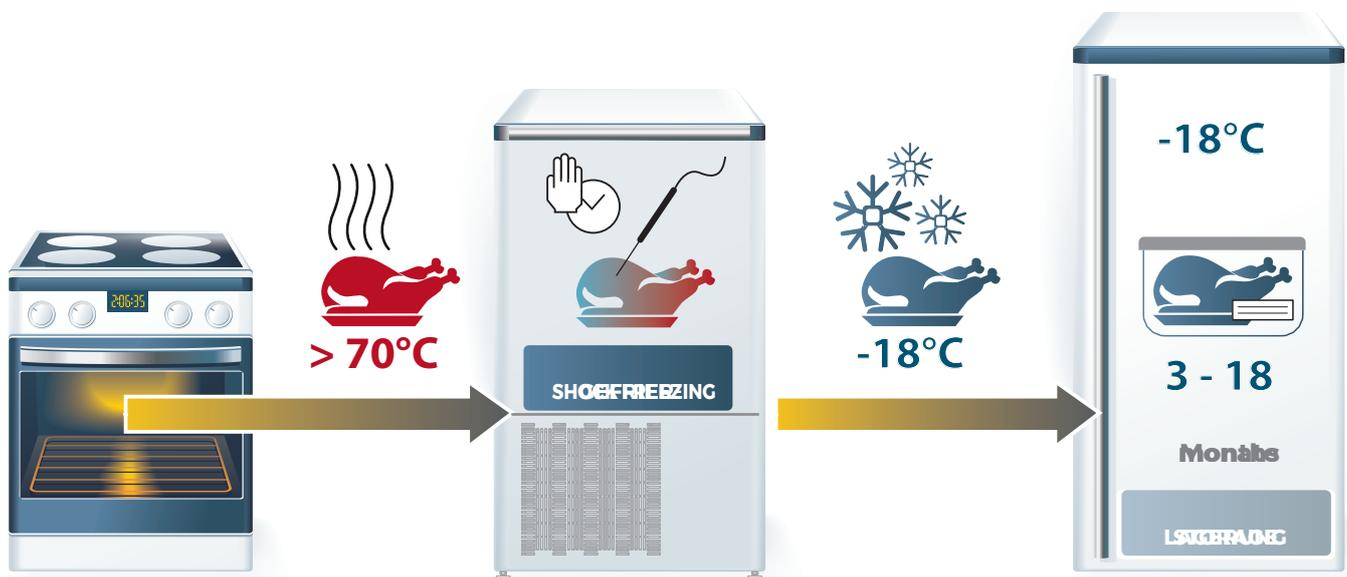
Durch **Tiefkühlen** (oder negative Schnellkühlung) wird die Temperatur des Produkts in kürzester Zeit auf  $-18^{\circ}\text{C}$  im Kern reduziert. Das Produkt muss dann in einem Tiefkühlschrank bei einer konstanten Temperatur von  $-20^{\circ}\text{C}$  gelagert werden und kann nach 3/18 Monaten (je nach Art des Produkts) verzehrt werden, sofern die Kühlkette eingehalten wird. Starten ► S. 52
