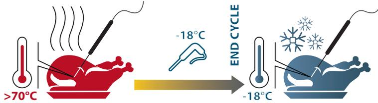
**AUTOMATISCH:** Der Bediener muss die Kerntemperatursonde in die schnellzukühlenden Lebensmitteln einführen. Auf diese Weise erfasst sie ständig die Kerntemperatur der Lebensmittel in der Zelle. Der Schnellkühlzyklus endet, **wenn die Sonde feststellt, dass die für den gewählten Zyklus eingestellte Temperatur erreicht ist** (z.B. -20°C).
