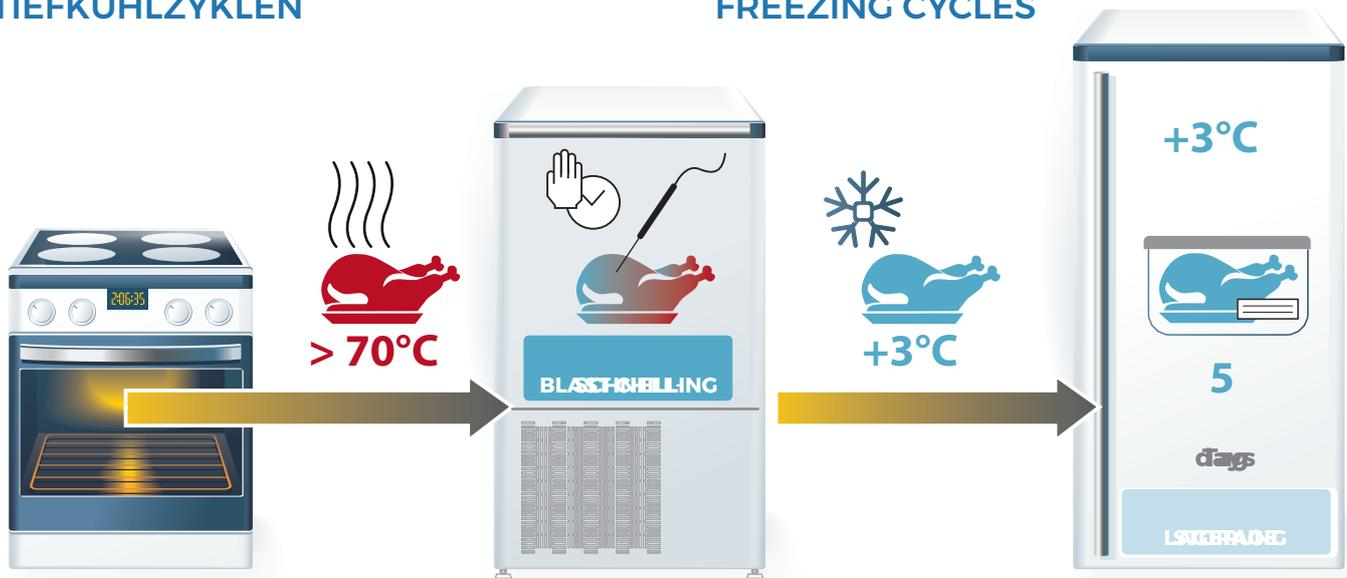
Die **positive Schnellkühlung** (oder Kühlung) reduziert die Temperatur des Produkts so schnell wie möglich auf  $+3^{\circ}\text{C}$  im Kern. Das Produkt muss dann im Kühlschrank bei einer Temperatur von  $0/+3^{\circ}\text{C}$  gelagert werden, wo es bis zu 5 Tage aufbewahrt werden kann. Starten ► S. 52
