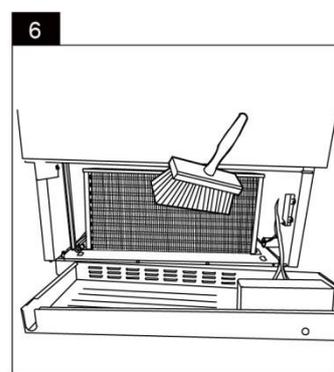
**Hinweis:** Dieser Eingriff am Gerät darf nur vom Kundendienst oder einer Fachfirma durchgeführt werden, da durch spannungsführende Teile die Gefahr eines Stromschlags besteht.
