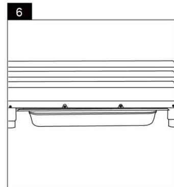
Ablage des Kerntemperaturfühlers bei Nichtgebrauch
