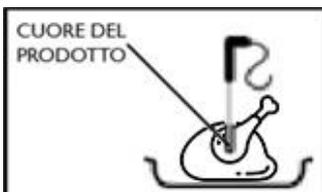
Quando lo spessore del prodotto lo consente, utilizzare sempre la sonda di temperatura a spillone, per conoscere l'esatta temperatura raggiunta al cuore del prodotto, si suggerisce, inoltre, di non interrompere il ciclo di abbattimento o aprire la porta prima che si sia raggiunta la temperatura di **+3°C**, in abbattimento positivo e **-18°C** per quello negativo.
