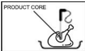
Wenn die Dicke des Lebensmittels es zulässt, können Sie den Kerntemperaturfühler verwenden und damit sicherstellen, dass exakt die gewünschte Kerntemperatur im Lebensmittel erreicht wird. Es empfiehlt sich, den Schockkühl- bzw. -frostzyklus nicht zu unterbrechen, bevor eine Temperatur von **+3 °C** beim Kühlen bzw. von **-18 °C** beim Tiefgefrieren erreicht ist.
