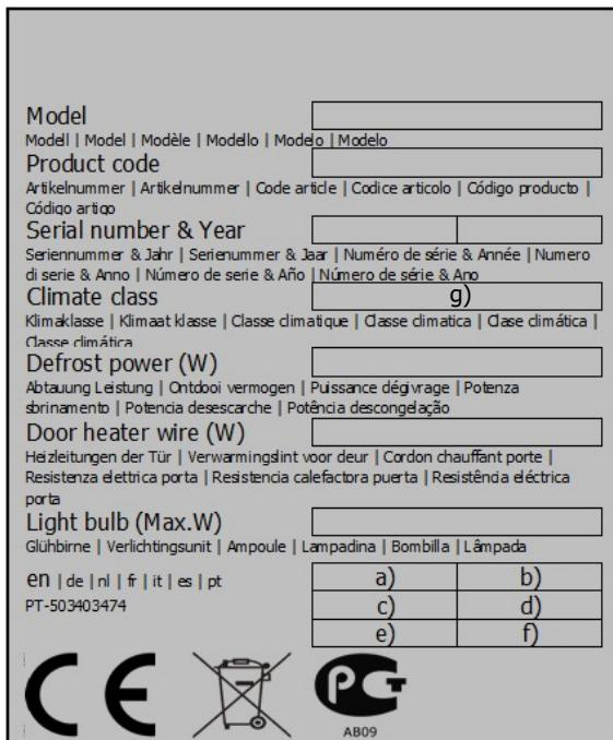
Un'etichetta delle caratteristiche delle nostre mini celle è posta all'interno della porta. Vi si possono trovare i principali dati tecnici dell'apparecchiatura e l'identificazione del MODELLO e N° di SERIE, importanti per la qualsiasi richiesta al fabbricante.
