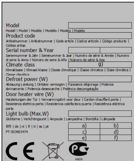
Het typeplaatje bevindt zich aan de binnenzijde van de deur. Daar vindt u de belangrijkste technische gegevens van het apparaat en de beschrijving van het MODEL en het SERIENUMMER. U hebt die gegevens nodig als u om welke reden dan ook contact opneemt met de fabrikant
