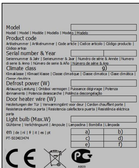
A placa de características das nossas mini câmaras vai colocada no interior da porta. Nela encontrará os principais dados técnicos do equipamento e a identificação do MODELO e Nº SÉRIE, fundamentais para qualquer consulta ao fabricante.
