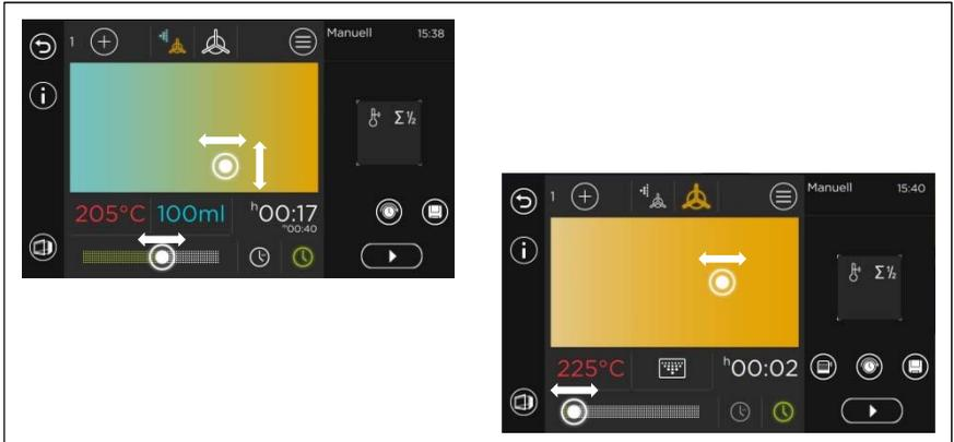
Abb. 15: Auswahl Temperatur, Beschwagung, Back- bzw. Ruhezeit mittels *Climatic\*MT-Screen*
