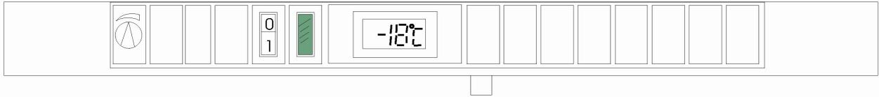
Der Thermostat kann auf eine Skala von 1-7 eingestellt werden, das entspricht ca. -15 bis -25°C. Eine Einstellung auf 3-4 ist in den meisten Fällen das Optimale. Das Kühlsystem kann abgeschaltet werden, indem Sie auf Stellung 0 drehen.
