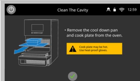
Wenn der Abkühlvorgang abgeschlossen ist, entfernen Sie vorsichtig die Abkühlschale aus dem Garraum, wobei Sie Schutzhandschuhe tragen müssen. Die Wasserschale sollte nicht über Nacht oder bei Kälte im Schnellgarsystem bleiben.
