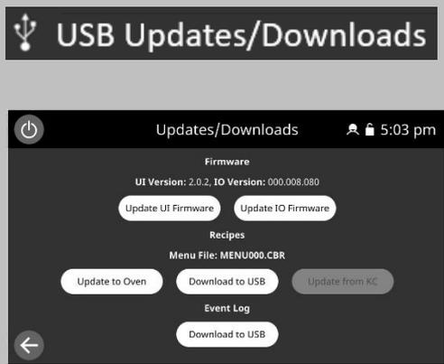
1. Schließen Sie einen USB-Stick an, wie im folgenden Abschnitt 8.2.7 beschrieben, und tippen Sie auf „USB-Updates“, um Firmware und Menüprogramme manuell auf das Kombigerät zu laden oder eine der folgenden Dateien vom Gerät auf den USB-Stick zu kopieren.
