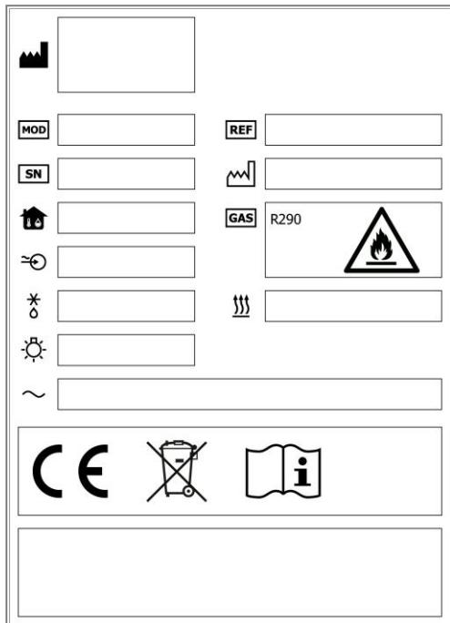
Het typeplaatje bevindt zich aan de binnenzijde van de deur. Daar vindt u de belangrijkste technische gegevens van het apparaat en de beschrijving van het MODEL en het SERIENUMMER. U hebt die gegevens nodig als u om welke reden dan ook contact opneemt met de fabrikant
