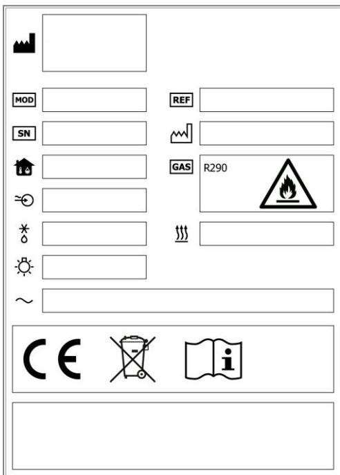
Das Typenschild unserer Geräte befindet sich innerhalb des Geräts, auf der linken innen Wand. Hier finden Sie die wichtigsten technischen Daten der Anlage und die Identifizierung des MODELLS und der SERIENNUMMER. Letztere sind für irgendwelche Nachfragen beim Hersteller notwendig.
