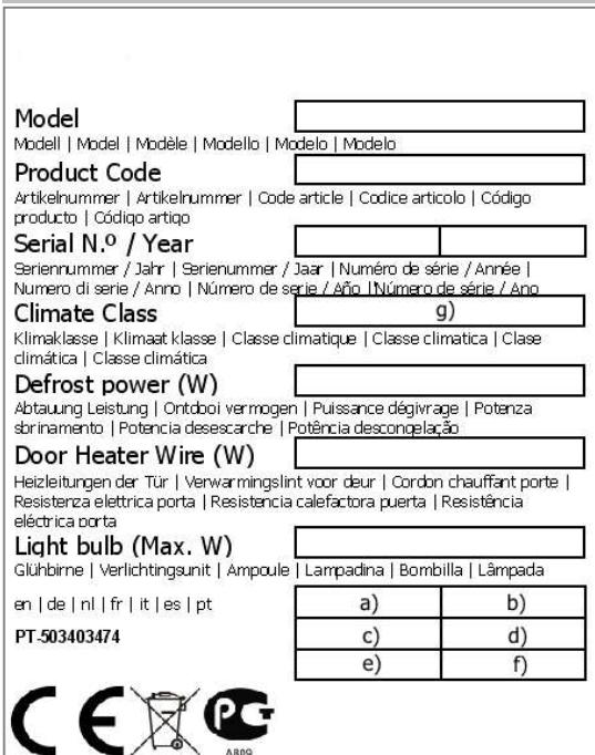
Un'etichetta delle caratteristiche delle nostre apparecchiature è posta all'interno della apparecchiatura, nel pannello laterale sinistro. Vi si possono trovare i principali dati tecnici dell'apparecchiatura e l'identificazione del MODELLO e N° di SERIE, importanti per la qualsiasi richiesta al fabbricante.
