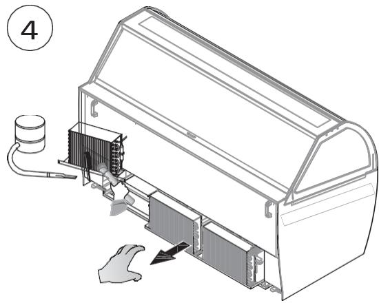
Entfernen Sie die hinteren Gitter wie angegeben. Ziehen Sie die Verflüssigereinheit wie angegeben heraus. Reinigen Sie den Kondensator mit einer geeigneten Bürste mit weichen Borsten und einem Staubsauger, wobei Sie darauf achten müssen, die Kondensatorfolien nicht zu verbiegen.
