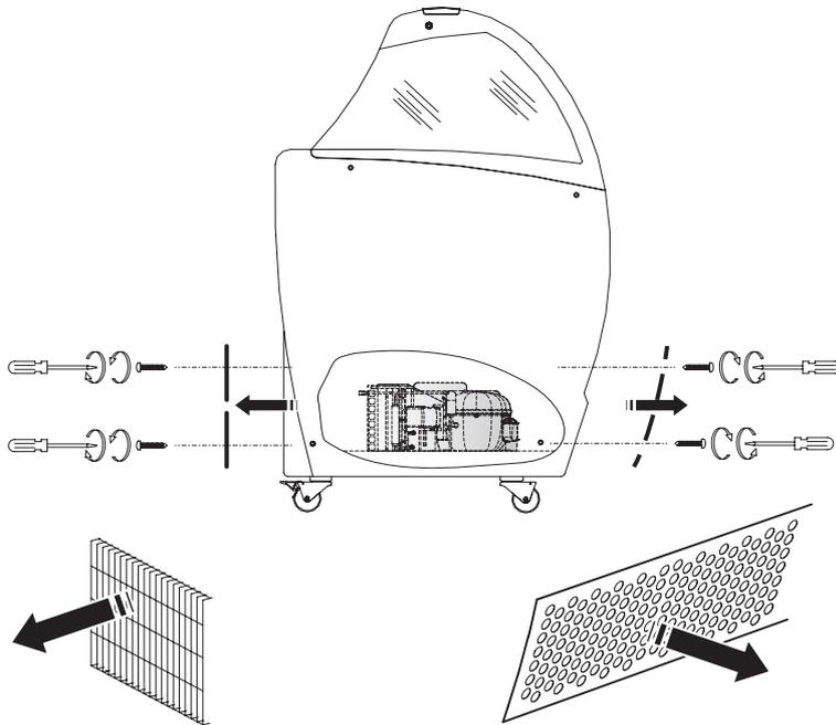
Reinigen Sie die Kondensateinheit mit einer Bürste mit weichen Borsten und einem Staubsauger; führen Sie die folgenden Schritte durch bei dieser Operation darauf achten, nicht die Lamellen des Kondensators zu verbiegen.
