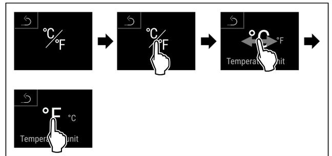
Fig. 87 Beispielhafte Darstellung: Von Grad Celsius zu Grad Fahrenheit wechseln.
