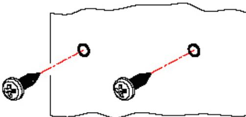
Verwenden Sie 4,8 x 38 mm. Schrauben, DIN NO:7981.
