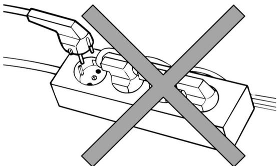
Der Schrank soll nicht einer mehrpoligen Anschlussdose angeschlossen werden.
