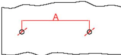
Bohren Sie zwei Löcher mit einem Durchmesser von 8 mm und einer Tiefe von 40 mm, mit dem angegebenen Abstand A.
