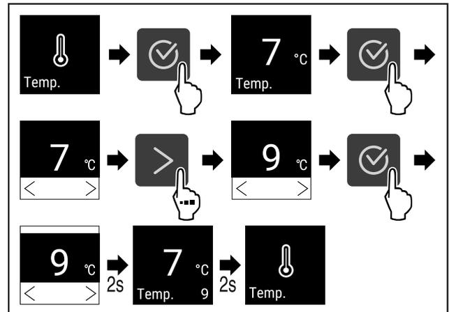
Fig. 95 Temperaturwechsel von 7 °C auf 9 °C
