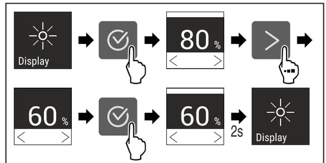
Fig. 128 Beispielhafte Darstellung: Von 80 % zu 60 % wechseln.
