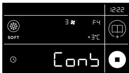
Während der Phase der **positiven Konservierung** (die automatisch jedem **Schnellkühlzyklus** folgt) wird die Temperatur in der Zelle auf +2 °C gehalten.
