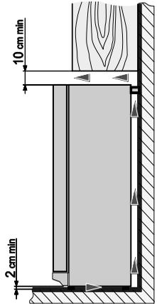
**Schema des zum Betrieb des Kühlschranks erforderlichen Außenraumes. Außenabmessungen für die Installation** (siehe Abb.)
