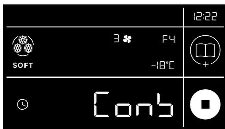
Während der Phase der **negativen Konservierung** (die automatisch jedem **Tiefkühlzyklus** folgt) wird die Temperatur in der Zelle auf -18 °C gehalten.
