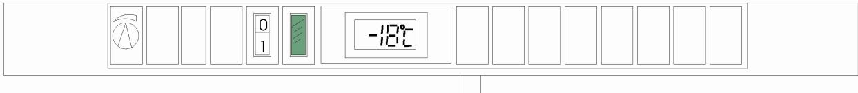
La posición normal del termostato será entre aprox. -15 °C y -25 °C.
