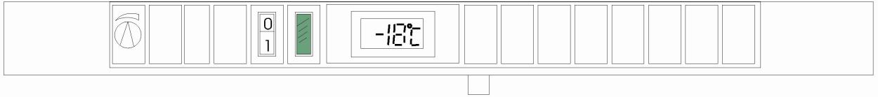
Der Thermostat kann auf eine Skala von 1-7 eingestellt werden, das entspricht ca. -15 bis -25°C.
