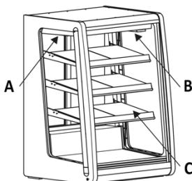
A - Luftansaugung. Blockieren Sie niemals die Ansaugung. Es wird Luft angesaugt und kalte Luft im Inneren des Kühlschranks umgewälzt.
