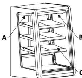
A - Luftsugning. Bloker aldrig suget. Luft suges ind og kold luft cirkulerer inde i køleskabet.
