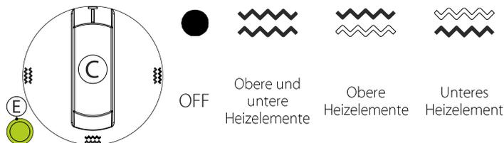
leuchtet auf und zeigt an, dass die Heizwiderstände in Betrieb sind.
